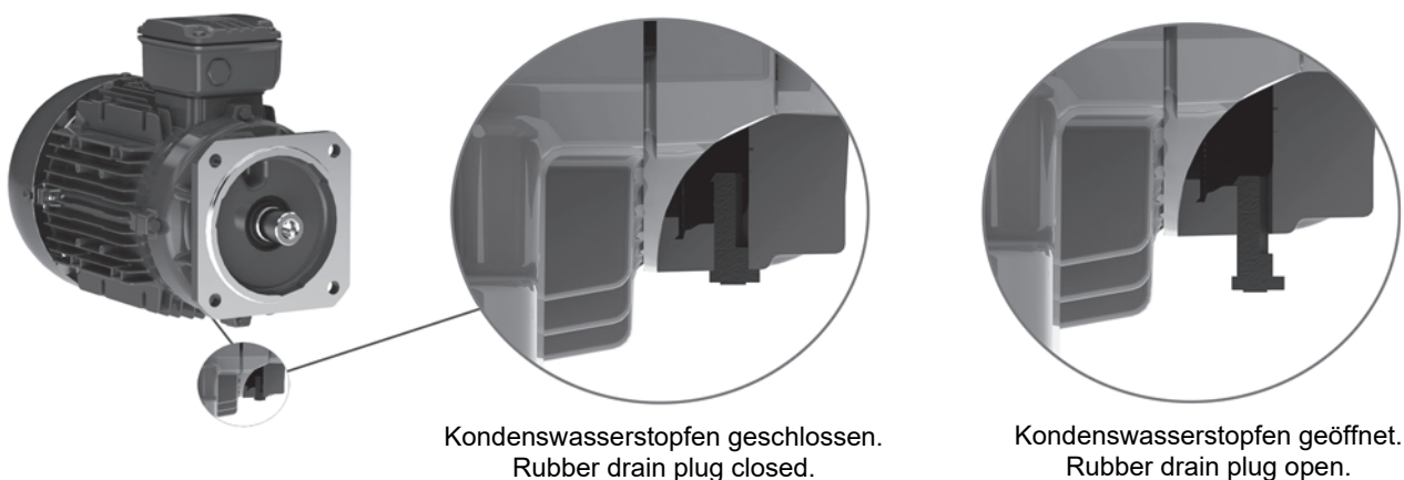
Bild 21: Detail des Kondenswasserstopfens am Lagerschild.
